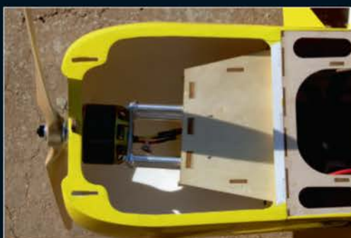
Le gros moteur brushless Scorpion SII 6350 semble perdu dans le grand capot moteur! Notez l'angle d'anti-couple impressionnant donné par la cloison pare-feu.
