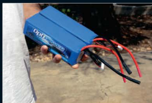
L'accu de propulsion est constitué de deux packs LiPo 6S 5300 mAh 50C de la marque Optipower.
