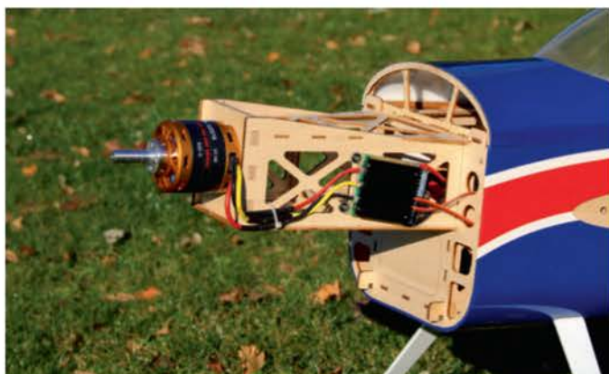
L'électrique brille par sa sobriété: quatre points de fixation, deux colliers Rilsan pour le contrôleur et surtout aucune découpe pour le loger sous les capots les plus fins. Le contrôleur devra être disposé dans un emplacement ventilé, c'est sa seule contrainte.
