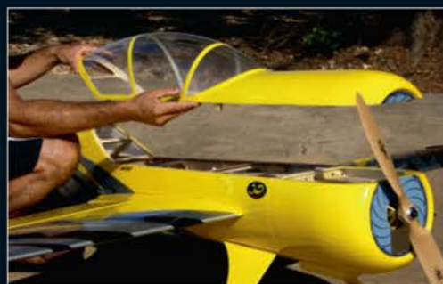
Le maniement de l'immense bulle doit se faire avec précaution, surtout qu'il faut la démonter après chaque vol (dans le cas d'une motorisation électrique). Elle est fixée par cinq vis de 3 mm.
