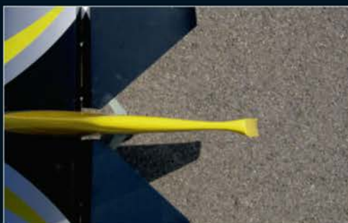
Les gouvernes de profondeur et de dérive ont un profil très particulier: le bord de fuite s'épaissit afin d'augmenter leur efficacité.
