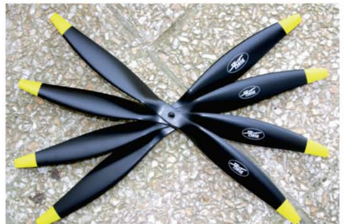
Les hélices testées sont des Fiala en bois, de la série Electro : de 23x10 à 25x10.
