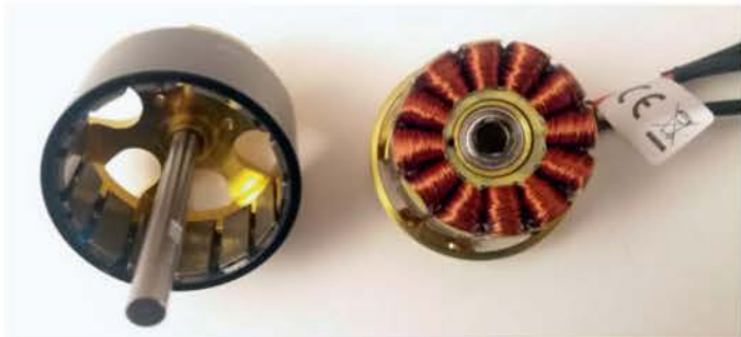
La qualité de fabrication est de très haut niveau, avec par exemple des colles (pour fixer les aimants) qui résistent à de hautes températures. N.B.: le moteur démonté n'est pas le 6350 mais un autre moteur de la gamme, plus petit.
