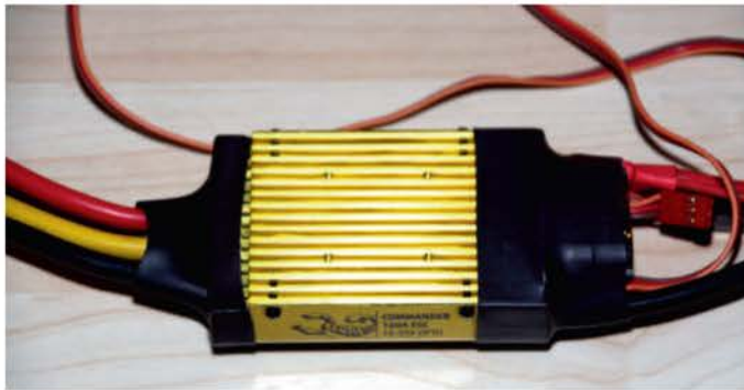
Le contrôleur Commander 160 A est à la hauteur du moteur : impressionnant. Le boîtier en aluminium anodisé possède un radiateur sur la totalité d'une face.
