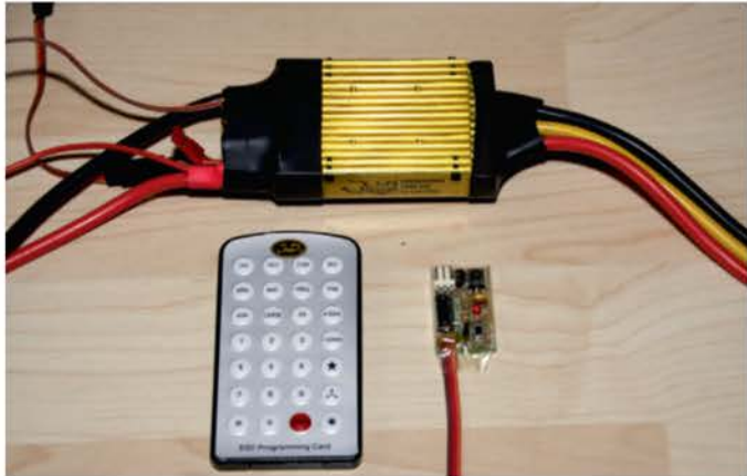
La programmation se fait avec cette carte, connectée au contrôleur par infrarouge.
