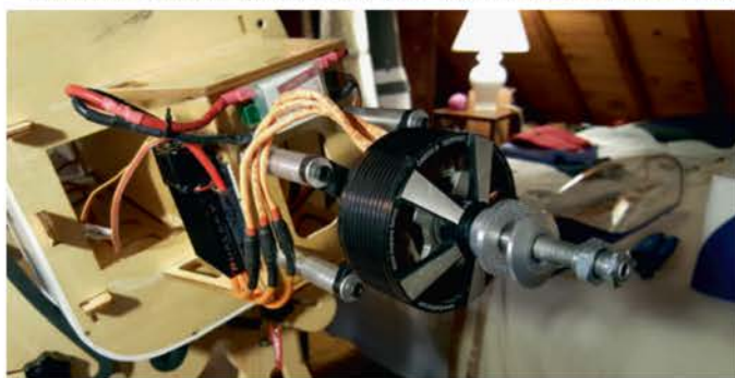
Le brushless Dual Sky GA 600.8, alimenté avec un LiPo 12S, est un moteur de milieu de gamme qui remplacera un thermique de 50 à 60 cm 3 .
