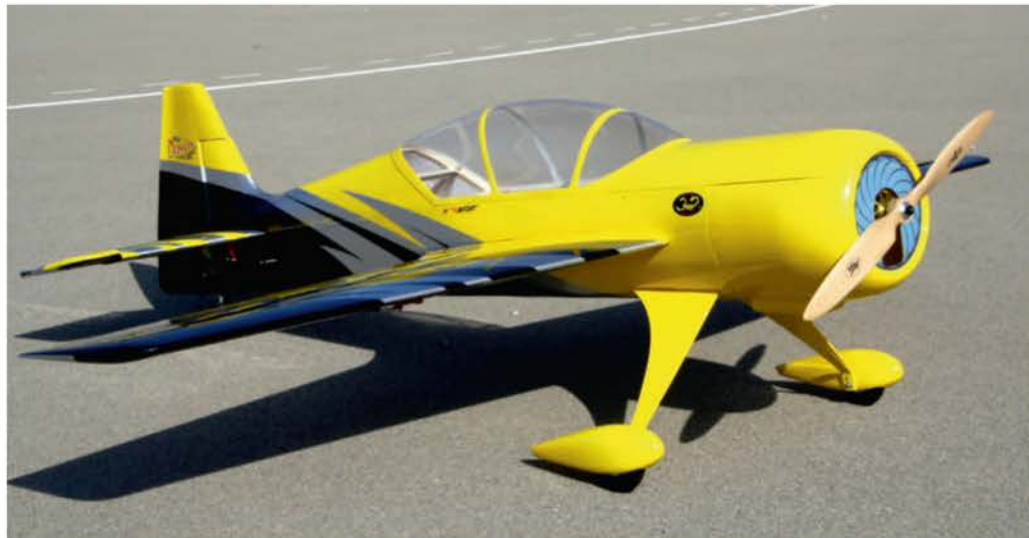
Le modèle est ici motorisé avec un gros brushless Scorpion, d'une puissance de plus de 4000 W, et un accu LiPo 12S de 5300 mAh.
