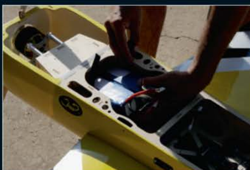
La mise en place et la fixation des accus est facile grâce au bon accès. Deux sangles viennent solidement arrimer cette masse de 1,7 kg.
