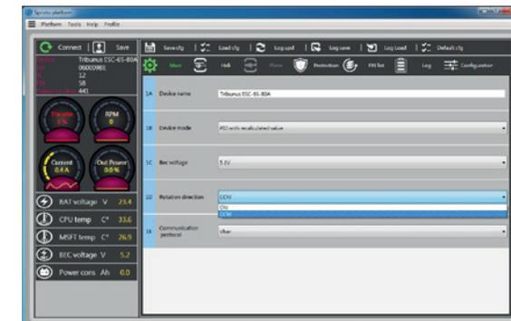
**Communication Protocol:** Elija "Standard" si usa el Governor Interno o el modo Avion. Elija VBar si utiliza Mikado VBar Control. Elija "Jeti Exbus" si utiliza Jeti Exbus System o elija "Unsc Telem" cuando utilice otro sistema de telemetría diferente (Como JLog o Brain FBL).
