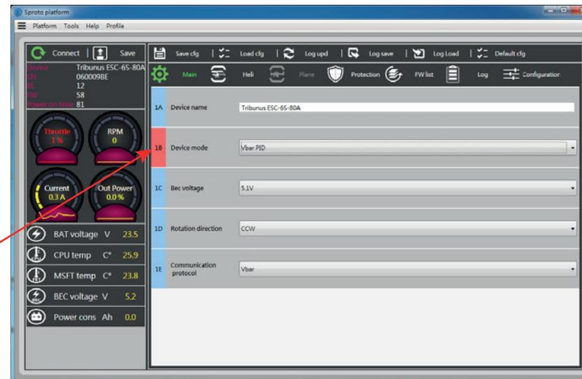
**BEC VOLTAGE:** La tensión del BEC puede ajustarse de 5.1V a 8.3V.
