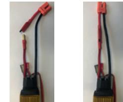
Antes de conectar la batería, el cable del Anti Spark debe estar desconectado. Conecte la batería al conector con carcasa. Después conecte el cable positivo (+) que viene del variador al Fusible reinicialable PTC durante un segundo y deslice conectándolo con el conector hembra positivo. No habrá chispa durante la conexión.
