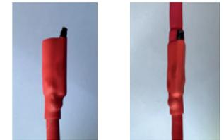
Conecte el cable negativo (-) primero wire first. Después conecte el cable positivo (+) que viene del variador al Fusible reiniciable PTC durante un segundo y deslice conectándolo con el conector hembra positivo. No habrá chispa durante la conexión.
