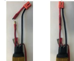
Antes de conectar la batería, el cable del Anti Spark debe estar desconectado. Conecte la batería al conector con carcasa. Después conecte el cable positivo (+) que viene del variador al Fusible reiniciable PTC durante un segundo y deslice conectándolo con el conector hembra positivo. No habrá chispa durante la conexión.
