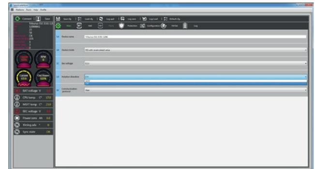
**Communication Protocol:** Elija "Standard" si usa el Governor Interno o el modo Avion. Elija VBar si utiliza Mikado VBar Control. Elija "Jeti Exbus" si utiliza Jeti Exbus System, elija "Unsc Telem" cuando utilice otro sistema de telemetría diferente (Como JLog o Brain FBL) o elija Futaba Sbus 2 si utiliza Futaba Sbus 2.
