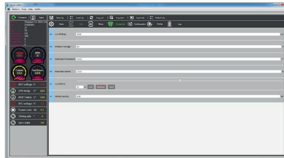
**ATENCIÓN** Todos los ajustes del ESC se borran al actualizarse el Firmware.. Guarde los ajustes antes de actualizar el Firmware.
