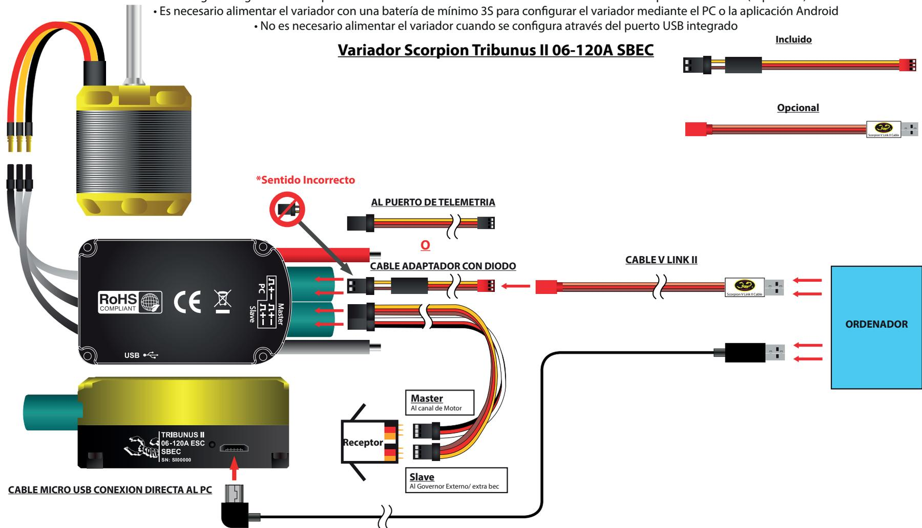
Puede descargar el manual, software y driver V Link II en la web.
