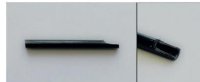
6) deslice el tubo de plástico por la pata del Fusible reiniciable PTC y utilice CA para mantenerlo en su posición
