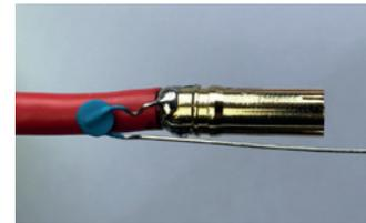
4) cubra el conector con termo-retráctil para aislar la otra pata del conector
