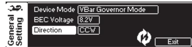
Tras un ajuste inicial del variador o un cambio de un parámetro, es necesario escribir los ajustes en el variador. Si en el panel "Store" pulsa el botón "Store", el variador se reiniciará, guardando todos los parámetros cambiados.
